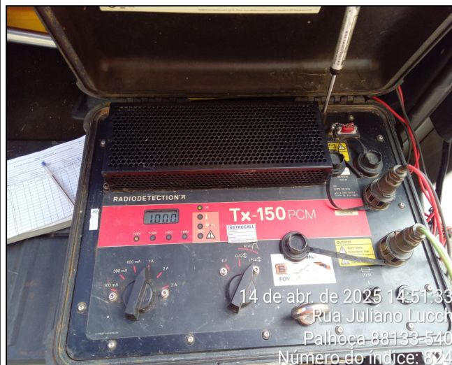
Figura 2 - Ponto de injeção de corrente - ERP.
